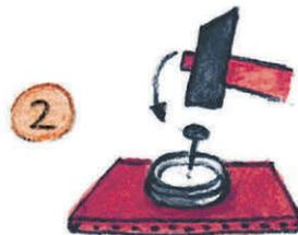
Wenn der Kleber getrocknet ist, schlag den Nagel durch die Deckel, sodass ein Loch entsteht – leg vorher ein Stück Pappe darunter!
