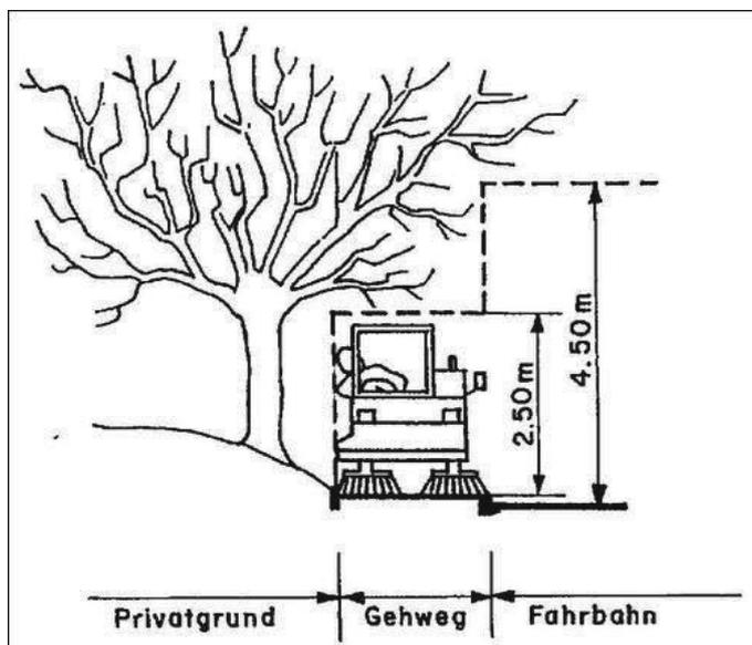
Der Sicherheitsraum über der Fahrbahn muss mindestens 4,50 Meter, bei Rad- und Gehwegen 2,50 Meter betragen. Der seitliche Abstand vom befestigten Fahrbahnrand muss mindestens 50 Zentimeter aufweisen.
